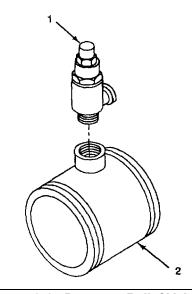
Figure 3-6. Pressure-Relief Valve
